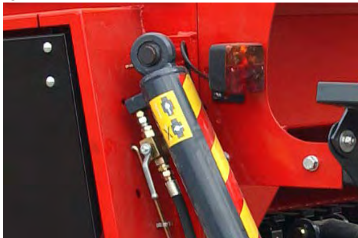
KUVA 20. Nostosylinterin turvaventtiili avattuna
