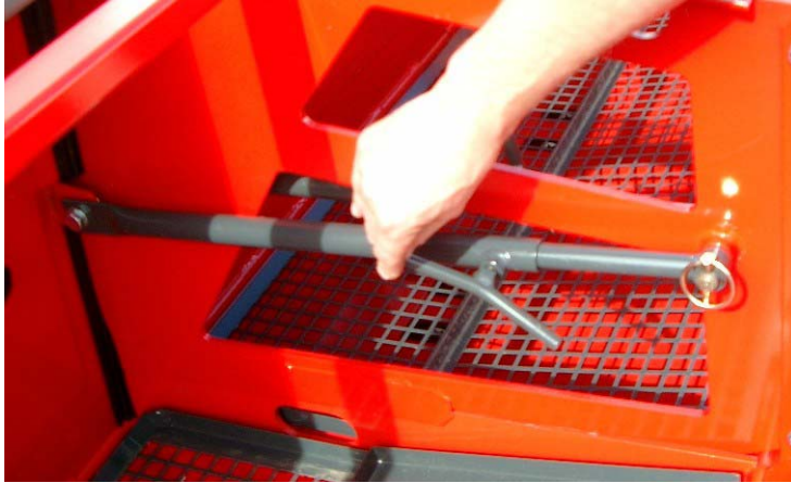
Kuva 8. Säiliön väliseinän säätötanko.
