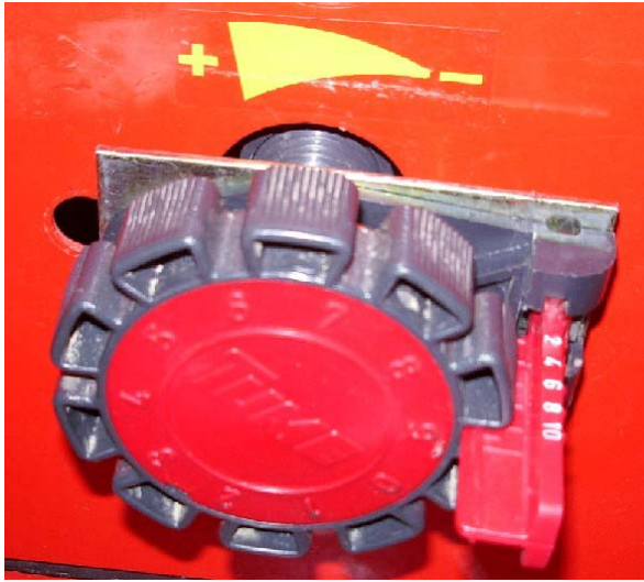
KUVA 9. Syötön säätö käsipyörästä
