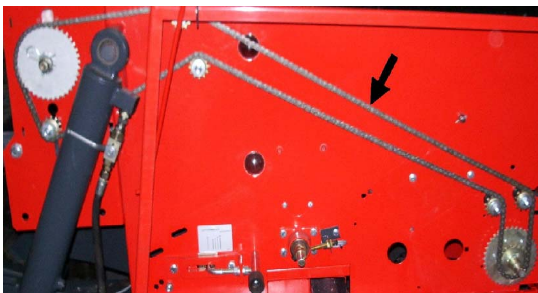
KUVA 21. HS-laitteen ketjujen asennus
