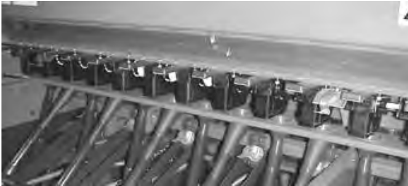
KUVA 15. Suppilohylly työnnetään eteen
