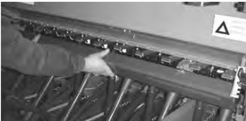
KUVA 17. Koekylvökaukalo käännetään ylös paikoilleen
