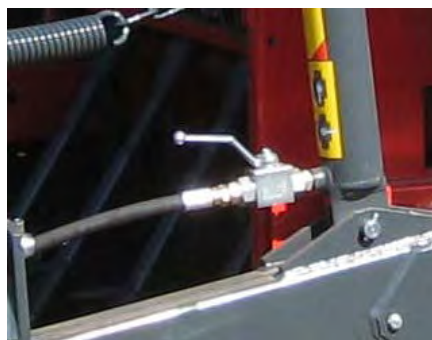
KUVA 34. Nostosylinterin turvaventtiili auki
