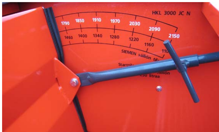
Kuva 13. Väliseinän säätötanko ja säiliöiden tilavuusasteikko
