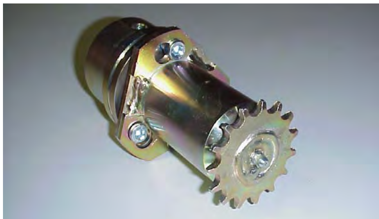
Kuva 10. Voimansiirron vapautuskytkin kylvöasennossa
