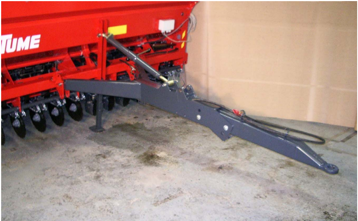
Kuva 5. monitoimivetoaisa alavetoaisana mekaanisella työntötangolla
