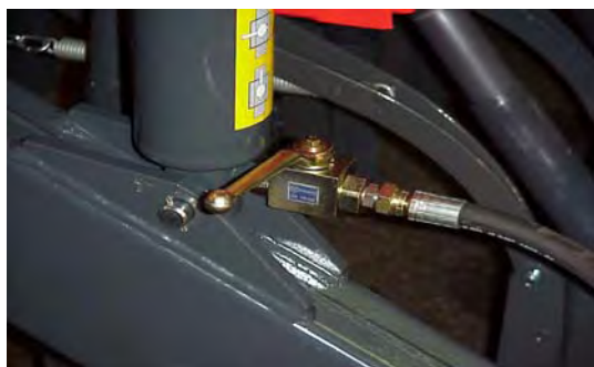
KUVA 33. Nostosylinterin turvaventtiili suljettuna
