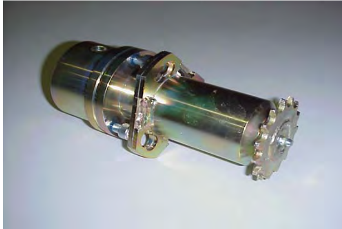
Kuva 9. Voimansiirron vapautuskytkin vapaa-asennossa siirtoajoa varten
