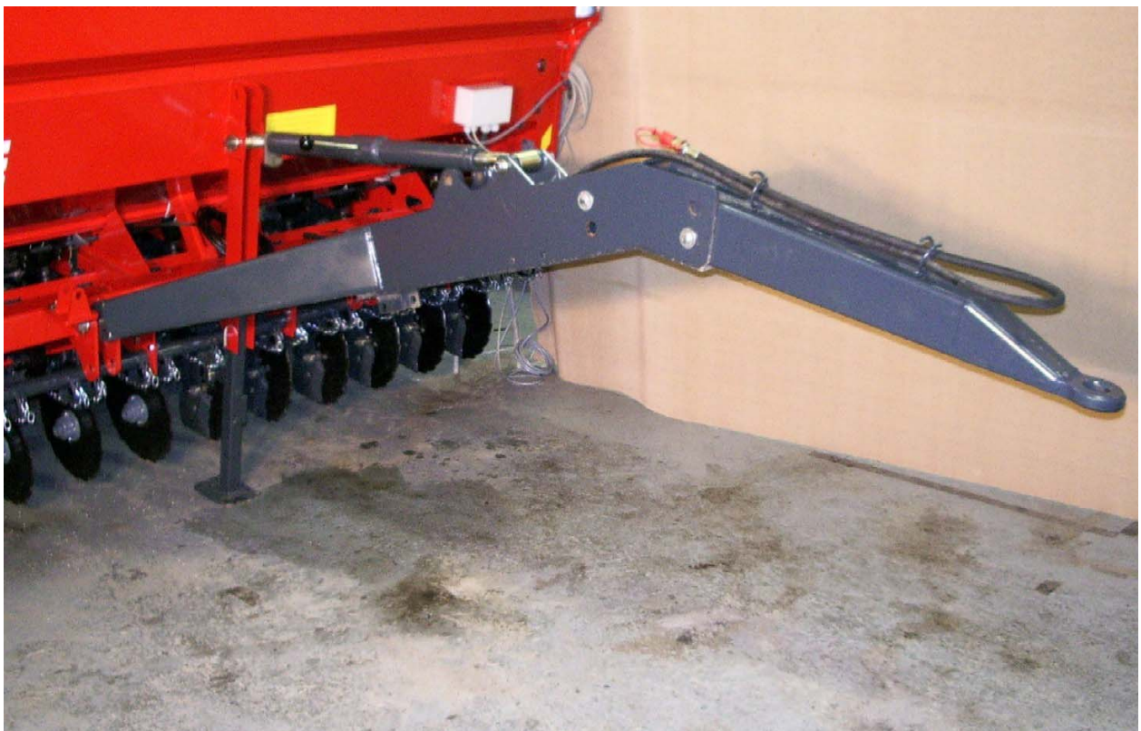
Kuva 6. Monitoimivetoaisa asennettuna yläpuoliseksi aisaksi
