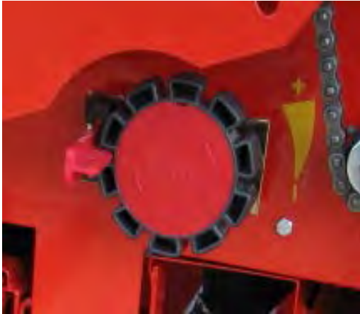
KUVA 9. Syötön säätö käsipyörästä
