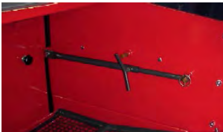
Kuva 8. Säiliön väliseinän säätötanko.
