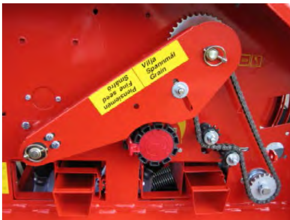
KUVA 11. Voimansiirtokasetti. I = Vilja, II = Pienisien
