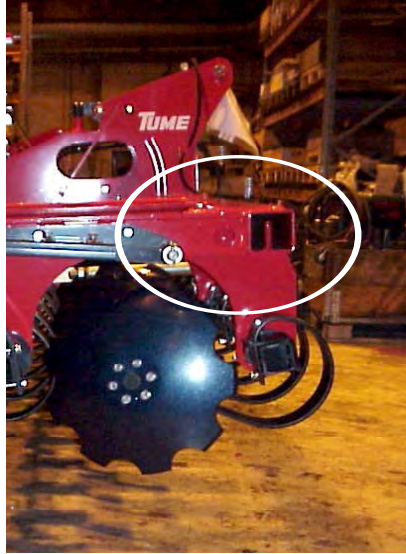
Kuva 5. Muokkaimen etupalkin sisään voidaan sijoittaa lisäpainoja
