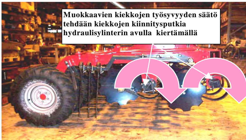
Kuva 2. Työsyvyys säädetään kiekkojen kiinnitysputkia kiertämällä. Kuvassa kuljetusasento.
